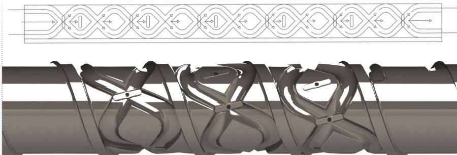
FIGURA 2 Una segunda versión del mezclador APS muestra el flujo desde el lado de arrastre y la parte final del canal a las ranuras. El flujo avanza también sobre la zona de entrada. Estos tres flujos convergen cuando avanza el ciclo de procesamiento. Esto se repite a lo largo de la zona de mezcla.
