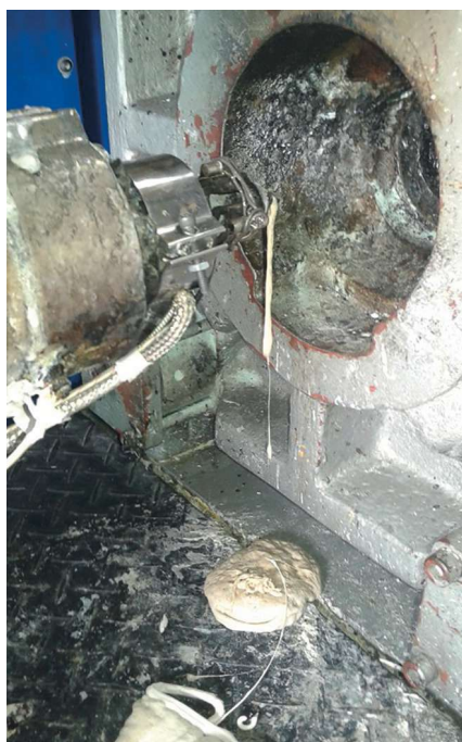
Purgado del cañón en la máquina de inyección.
