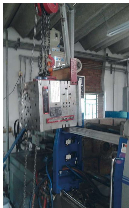
Desmontaje del molde de inyección.
